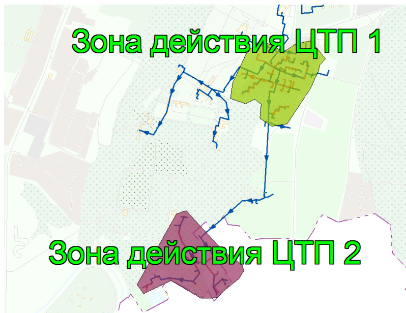
Рисунок 4. Ситуационная схема действия источников централизованного горячего водоснабжения.
