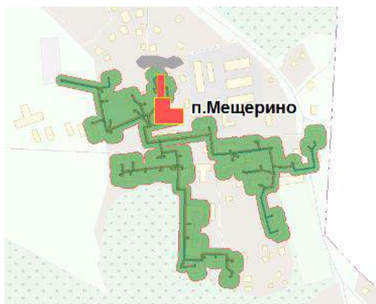
Рисунок 2.1.5.3 – Схема зоны действия ИЦВ горячей воды п. Мещерино
